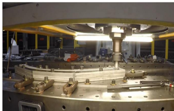
شکل ۳ ساخت افزودنی اصطکاکی اغتشاشی [۳]
