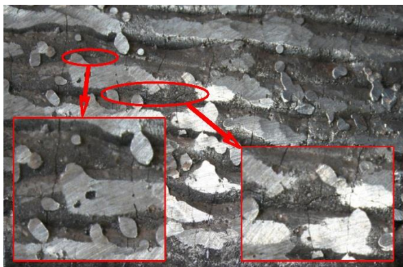
شکل ۲- ترک‌های طولی و عرضی بوجود آمده در لایه اول رسوب داده شده با فلز جوش MF-10-60-GRZ بدون انجام عملیات پیش گرمایش
