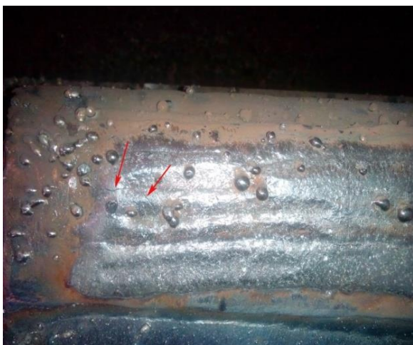
شکل ۵- ترک های طولی ایجاد شده در نمونه پس گرم شده با مشعل به مدت ۷ دقیقه
