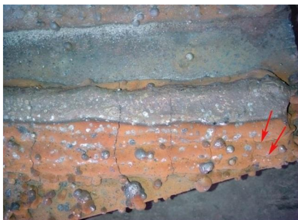
شکل ۶- ترک های طولی ایجاد شده در لایه دوم سرد شده زیر ماسه SiO_2
