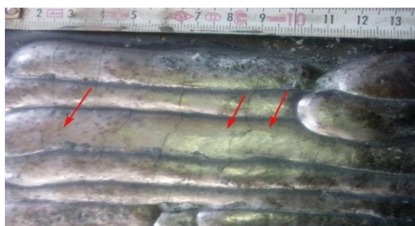
شکل ۹- ترک‌های طولی ایجاد شده در لایه سخت‌کاری شده در جوشکاری زیر پودری
