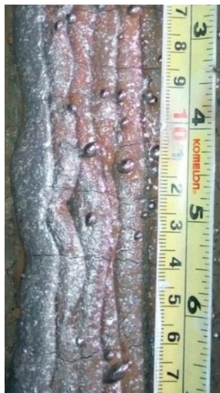
شکل ۷- اعمال لایه دوم با استفاده از فلز جوش MF-10-60-GRZ با دمای بین پاسی ۳۵۰ و ۷ دقیقه پس‌گرمایش
