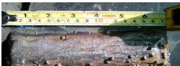
شکل ۱۲- جوش چهارلایه ER+MF10+ER+MF10 بدون هیچگونه ترک طولی در نمونه
