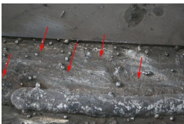
شکل ۳- ترک‌های طولی ایجاد شده بر روی لایه دوم جوشکاری شده توسط فلز جوش MF-10-60-GRZ
