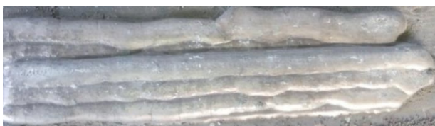
شکل ۸- لایه سخت‌کاری شده بوسیله جوش زیر پودری
