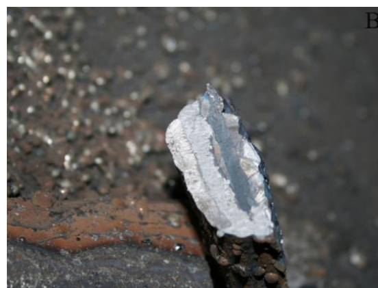
شکل ۱۱- (الف) بلند شدن فلز جوش از فلز پایه علت اعمال لایه سوم، (ب) سطح مقطع فلز کنده شده
