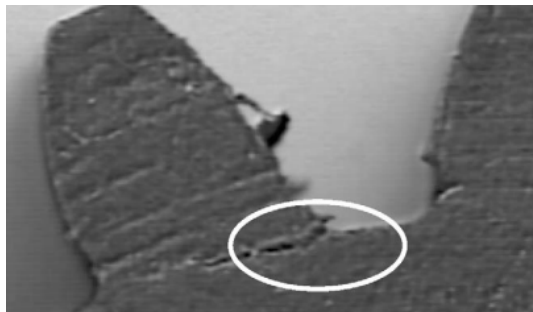
شکل ۸: رشد ترک در ریشه دنده برای چرخ‌دنده پلیمری حاوی الیاف کربن [۱۱].
