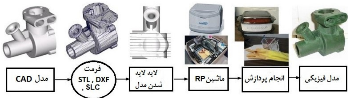
شکل ۲: فرآیند کلی ساخت مدل فیزیکی بر اساس نمونه سازی سریع [۵].
