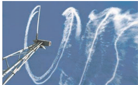
شکل ۱: تشکیل و گسترش دنباله پایین دست یک توربین بادی [۱]
