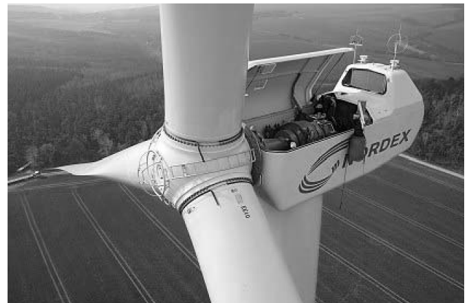
شکل ۱: پره‌ها و پوسته کامپوزیتی مولد الکتریکی در یک توربین بادی [۲]
