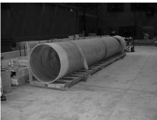
شکل ۵: نمایی از یک لوله کامپوزیتی مورد استفاده در ساخت پایه توربین بادی [۴]
