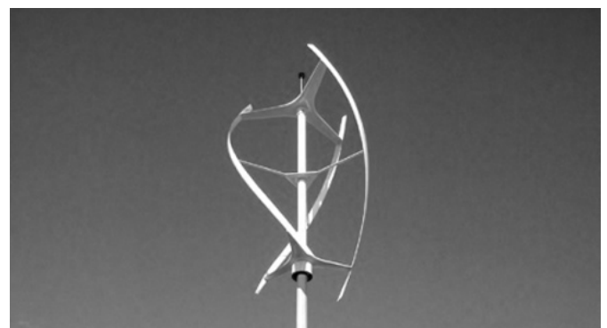
شکل ۲: پره‌های کامپوزیتی توربین بادی با محور عمودی [۲]
