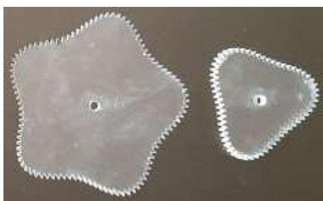
شکل ۶ چرخنده‌های غیردایروی مثلثی و پنج‌پر تولید شده به روش ساخت افزایشی
