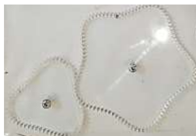
شکل ۷ چرخنده‌های غیردایروی مثلثی و پنج پر درگیر با هم پس از مونتاژ
