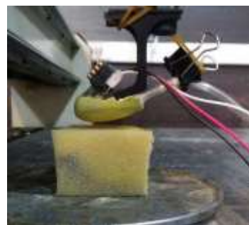
شکل ۶ نمونه نهایی انگشت در تست سفتی
