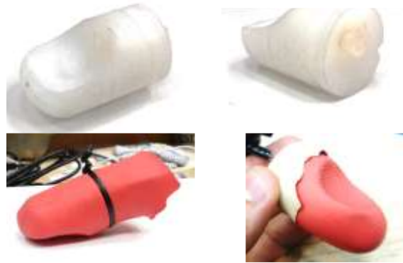
شکل ۲ اولین نمونه ساخته شده انگشت با پوشش کامل
