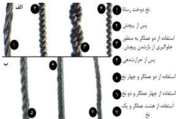
شکل ۱۶ الف- فرآیند ساخت عملگر پلیمری پیچ‌خورده و مارپیچ ب- انواع عملگرهای ساخته‌شده پلیمری پیچ‌خورده و مارپیچ [۵۷]
