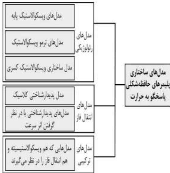
شکل ۱۱ مدل‌های ساختاری پلیمرهای حافظه‌شکلی پاسخگو به حرارت [۴۱]
