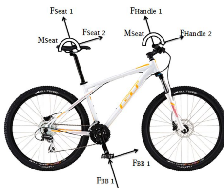
شکل ۱۰. نیروها و گشتاورهای وارد بر دوچرخه از طرف دوچرخه‌سوار [۲۸]
