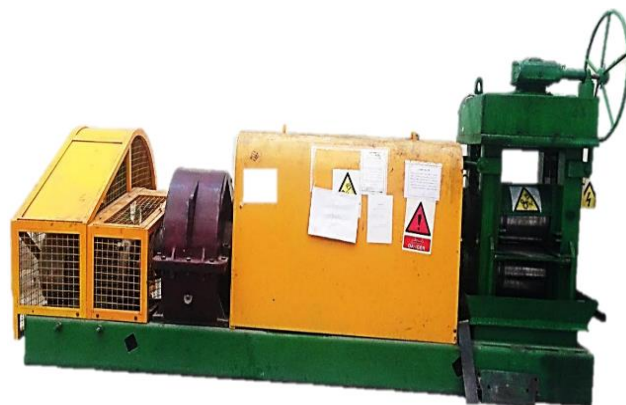
شکل ۳ دستگاه نورد مورد استفاده برای عملیات
