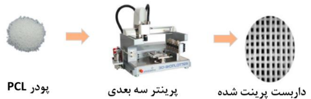
شکل ۱۸ داربست پرینت‌شده از جنس PCL [۱۵]
