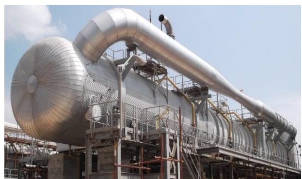
شکل ۱ آب شیرین کن تقطیر چند مرحله‌ای [۱۸]
