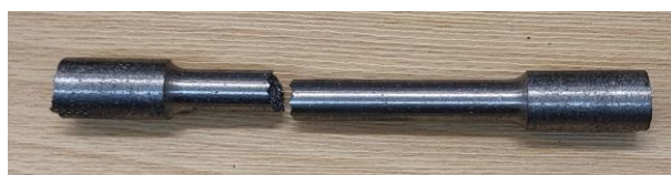
شکل ۱۴ تست کشش نمونه C
