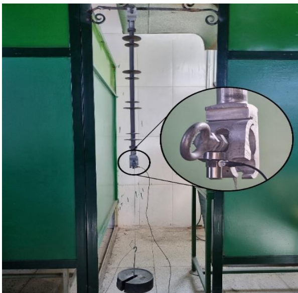
شکل ۴ نحوه اتصال جداکننده و شتاب سنج به منظور بدست آوردن ضریب میرایی
