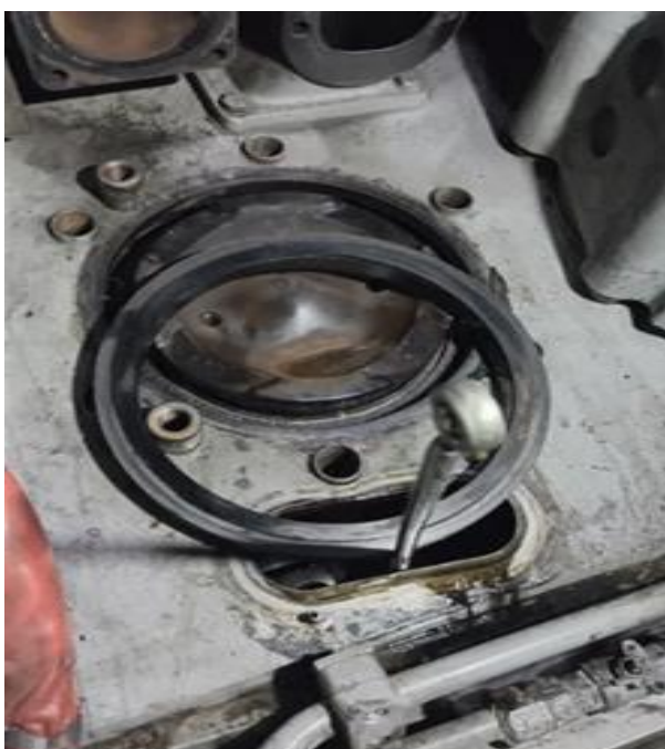
شکل ۵ فلنج شکسته لاینر B
