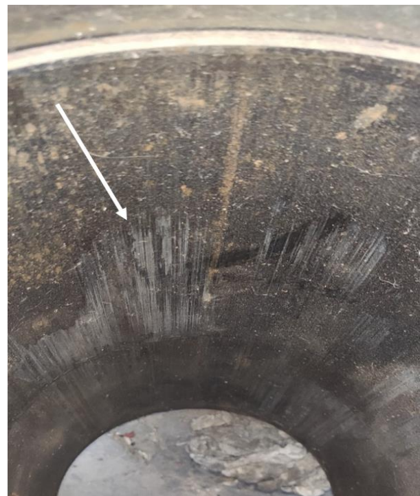
شکل ۷ خط و خش لاینر C
