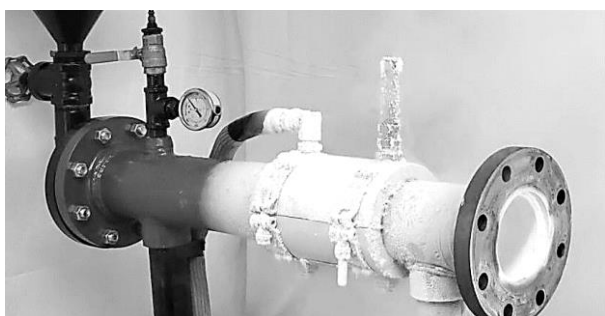
شکل ۴ وضعیت لوله پس از یخ زدن با بکارگیری ژاکت نیتروژن [۲۳]
