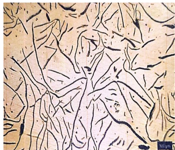
شکل ۱۸ لاینر C بزرگنمایی ۱۰۰X-گرافیت های ورقه ای
