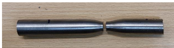
شکل ۱۲ تست کشش نمونه A
