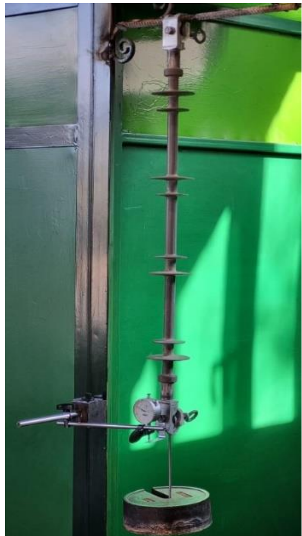
شکل ۳ نحوه نصب جداکننده و شرایط انجام آزمایش کشش
