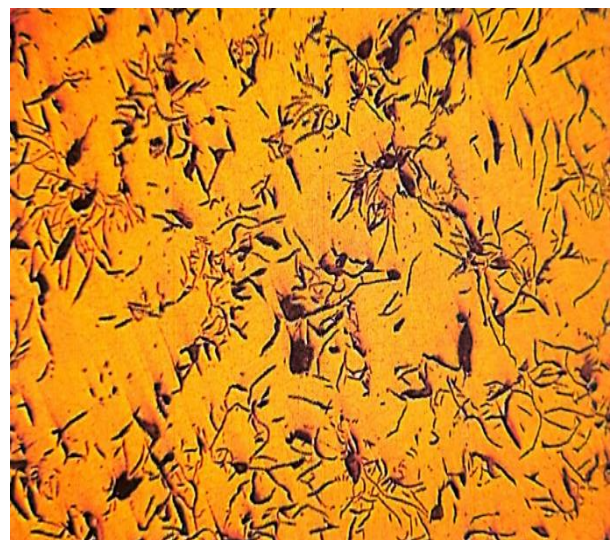
شکل ۱۷ لاینر B بزرگنمایی ۱۰۰X-گرافیت های ورقه ای
