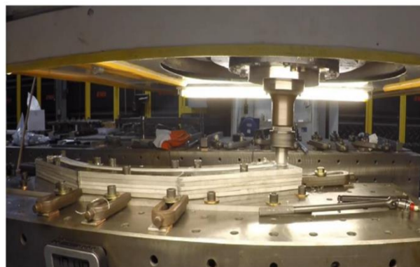
شکل ۳ ساخت افزودنی اصطکاکی اغتشاشی [۳]
