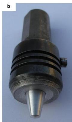
شکل ۱۲ ابزار جوشکاری نقطه‌ای پرکننده [۳۲].
