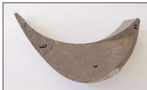
شکل ۲۰ وجود سه ناحیه مختلف در سطح شکست پره فولادی [۱۴۰]
