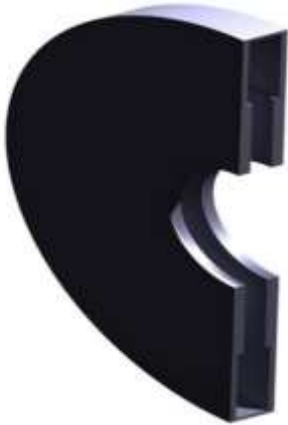
شکل ۳۲ نمای سه بعدی برش خورده دیسک دوجانه با پروفیل ضخامت پله بهینه
