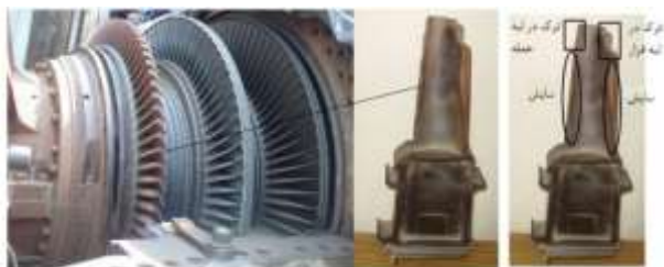
شکل ۲۱ نمای داخلی توربین گازی و تصویر پره شکسته شده مرحله اول در اثر خستگی و خوردگی داغ [۱۴۱]
