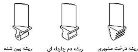
شکل ۵ انواع ریشه ها برای متصل کردن پره به دیسک
