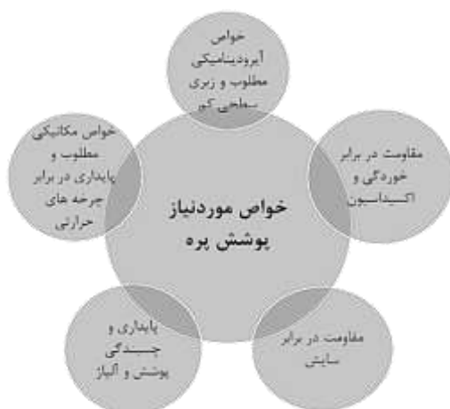
شکل ۱۳ خواص موردنیاز پوشش های پره های توربین
