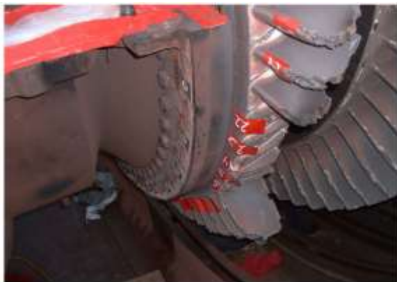
شکل ۱۶ شکست چهار پره متحرک ردیف اول توربین گازی در اثر خستگی کم‌چرخه [۱۳۷]
