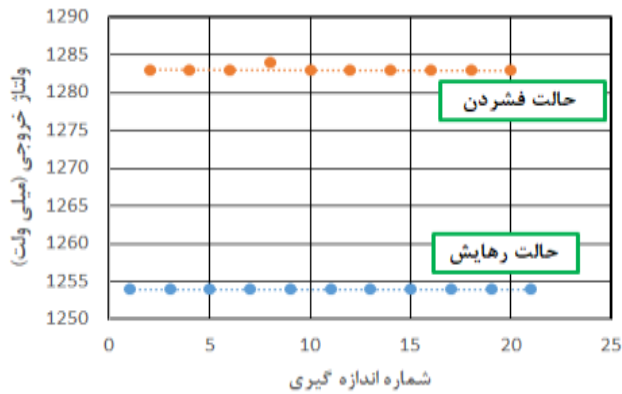
شکل ۱۱ تکرارپذیری عملکرد حسگر در فشار اولیه گیج ۹۳ / ۱۳ کیلوپاسکال و گام نیم میلیمتر
