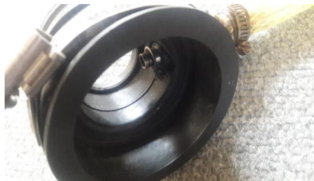
شکل ۲ محل نصب انژکتور در پشت دریچه گاز
