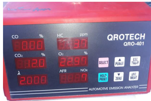
شکل ۱ دستگاه تست پنج گاز جهت اندازه‌گیری پارامترها
