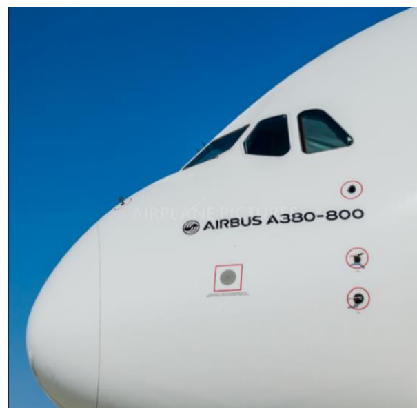
شکل ۹ پورت‌های ثابت و دریچه استاتیک نصب شده بر روی یک هواپیمای مسافربری ایرباس A380-800
