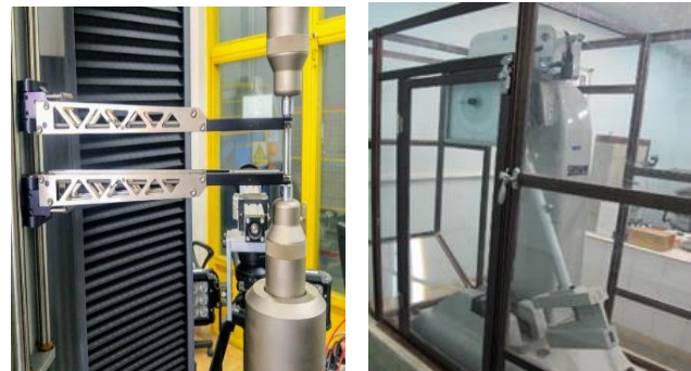
شکل ۲ دستگاه‌های آزمایش آنالیز شیمیایی، کشش و ضربه
