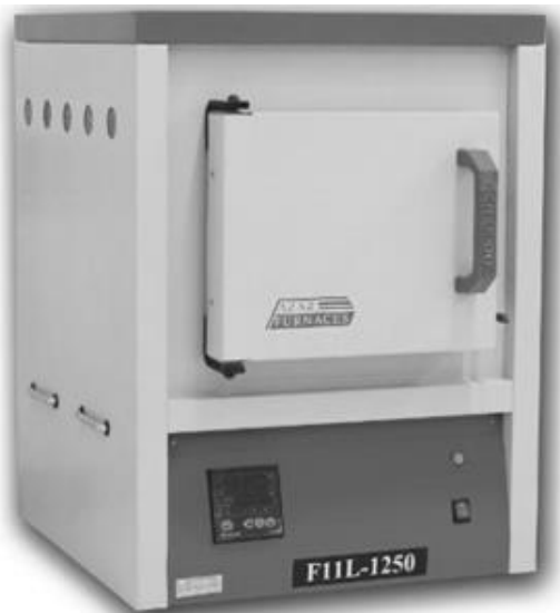
شکل ۲ کوره مورد استفاده برای آستینیت کردن نمونه
