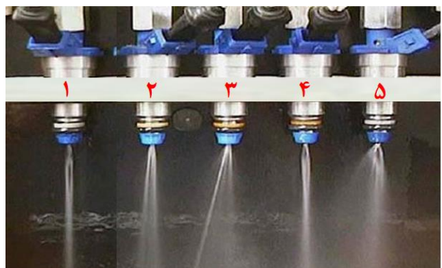
شکل ۴ نمونه‌های انواع پاشش سوخت در انژکتورها
