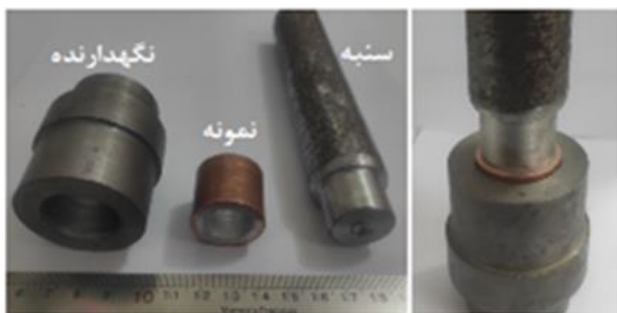
شکل ۳ الف- نمونه دو فلزی تولید شده در انتهای چرخه اول ب- در انتهای چرخه دوم
