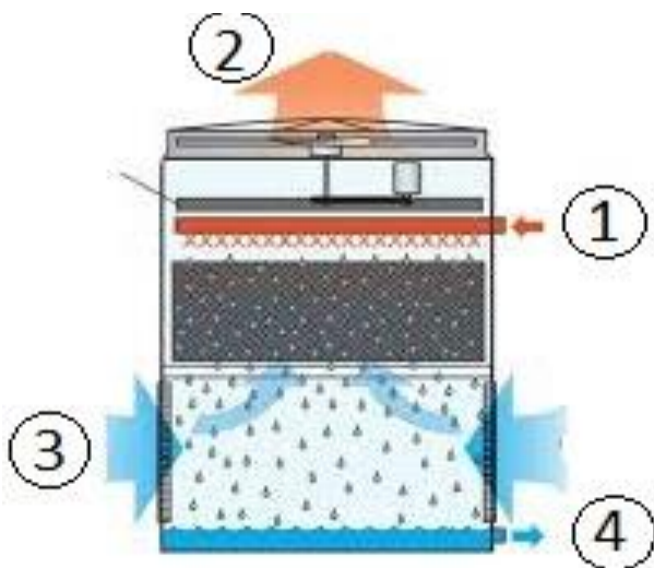
شکل ۱ شماتیک برج خنک‌کننده مورد استفاده در مطالعه حاضر ۱- ورود سیال، ۲- خروج هوا، ۳- ورود هوا، ۴- خروج سیال
