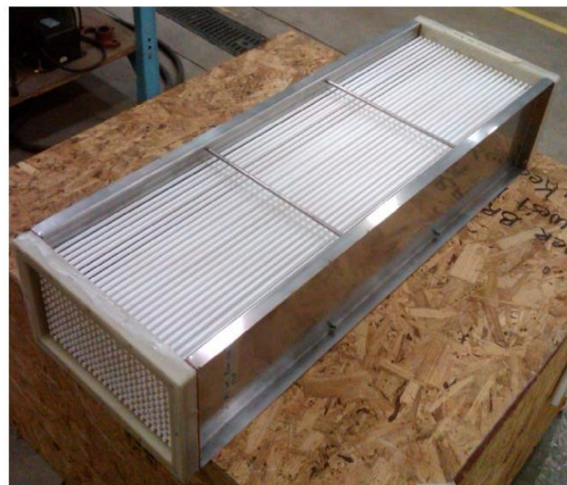
شکل ۸ نمونه ماژول TMC بلند طراحی و ساخته شده جهت کاربرد در بویلرهای نیروگاهی [۳۳]
