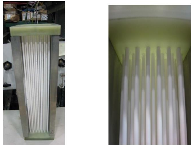
شکل ۴ ماژول TMC از جنس گارولیت [۳۴]
