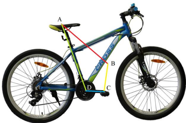
شکل ۲ مدل سازی عضوهای پا و رکاب در مکانیزم رکاب زنی
