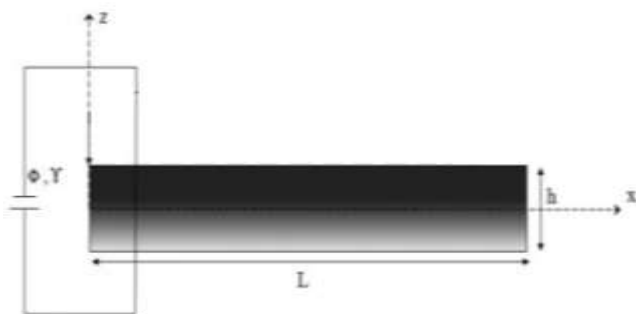
شکل ۱ نانوتیر مگنتوالکتروالاستیک تابعی و محورهای مختصات تحت بار میدان مغناطیسی و میدان الکتریکی خارجی
