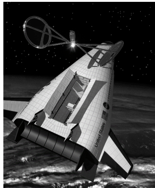
شکل ۳: نازل آترواسپایک خطی در پروژه فضاپیمای X-33 [۳].
