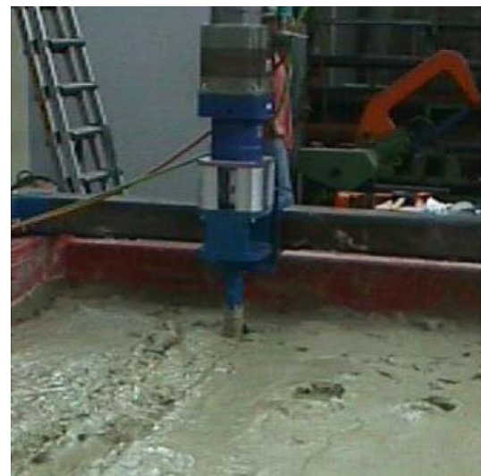
شکل ۳: مخلوط کردن آب و خاک رس مخصوص بعد از هر مجموعه از آزمایش [۷]
