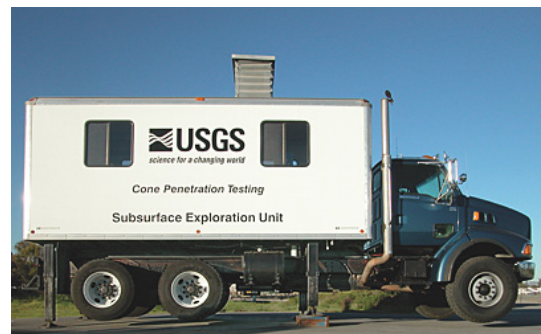
شکل ۲۴: کامیون حمل ادوات مربوط به آزمایش نفوذ مخروط مربوط به سازمان نقشه‌برداری‌های زمین‌شناسی آمریکا [۲۳]
