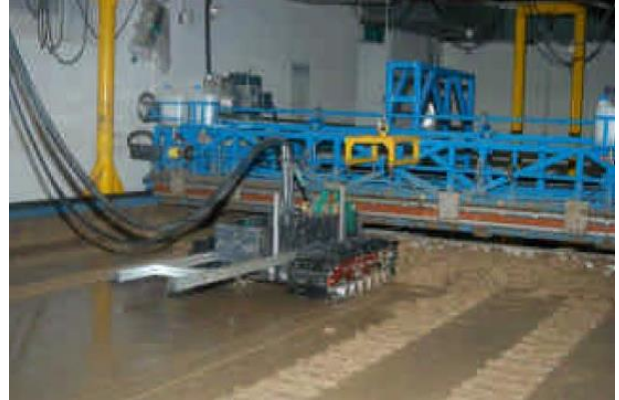
شکل ۱۶: تصویر وسیله نقلیه شنی دار که وزنه یدک به آن بسته شده و در انتظار حرکت است [۱۰]
