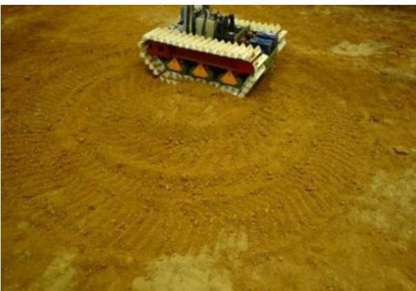
شکل ۲۰: نمونه وسیله نقلیه شنی‌دار برای آزمایش تجربی (آزمایش چرخش) [۶]
