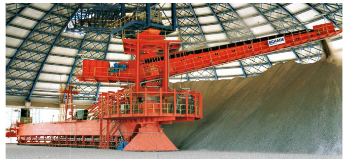
شکل ۷: ماشین انباشت بازویی دوار به همراه ماشین برداشت اسکرپر پلی در یک انبار دوار [۹]
