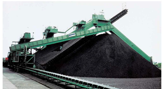
شکل ۱۸: ماشین انباشت و برداشت مرکب، ترکیبی از ماشین انباشت بازویی با اسکرپر دروازه‌ای [۹]
