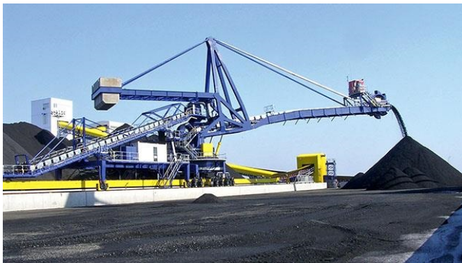
شکل ۱۷: ماشین انباشت و برداشت مرکب، ترکیب ماشین انباشت بازویی با چرخ بیل بازویی [۱۵]
