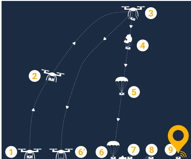
شکل ۵: مفهوم عملیات سامانه پهپاد رهاساز کن‌ست [۹]
