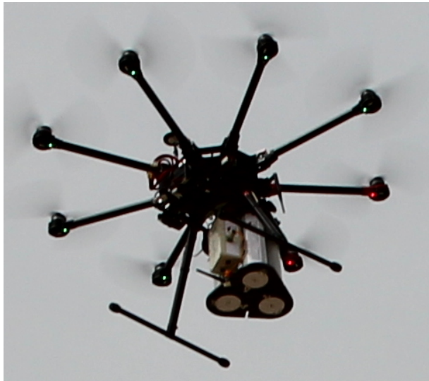
شکل ۳: سامانه یکپارچه پهپاد-رهاساز سه محفظه‌ای
