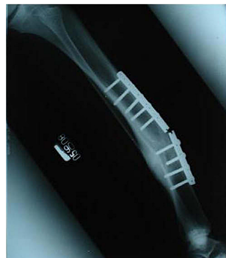
شکل ۵: تصویر رادیوگرافی شکست کاشتنی فولاد زنگ‌نزن ۳۱۶L در بدن بیمار [۵۱]
