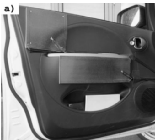
شکل ۷: نمونه‌ای از عناصر گرمایش اشعه مادون قرمز نصب‌شده در وسیله نقلیه آزمایشی تمام الکتریکی [۹]
