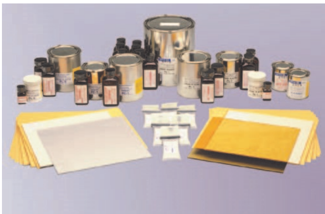
شکل ۲۵: پوشش مورد استفاده در تحلیل تنش تصویری: صفحات تخت، پلاستیک مایع برای ایجاد ورق‌های ریخته‌گری کنترل شده، چسب‌ها [۱۹].
