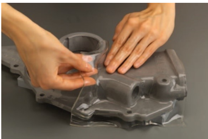
شکل ۹: پوشش شکل داده شده، در حال نصب بر روی پوسته پمپ آب هست [۱۳]
