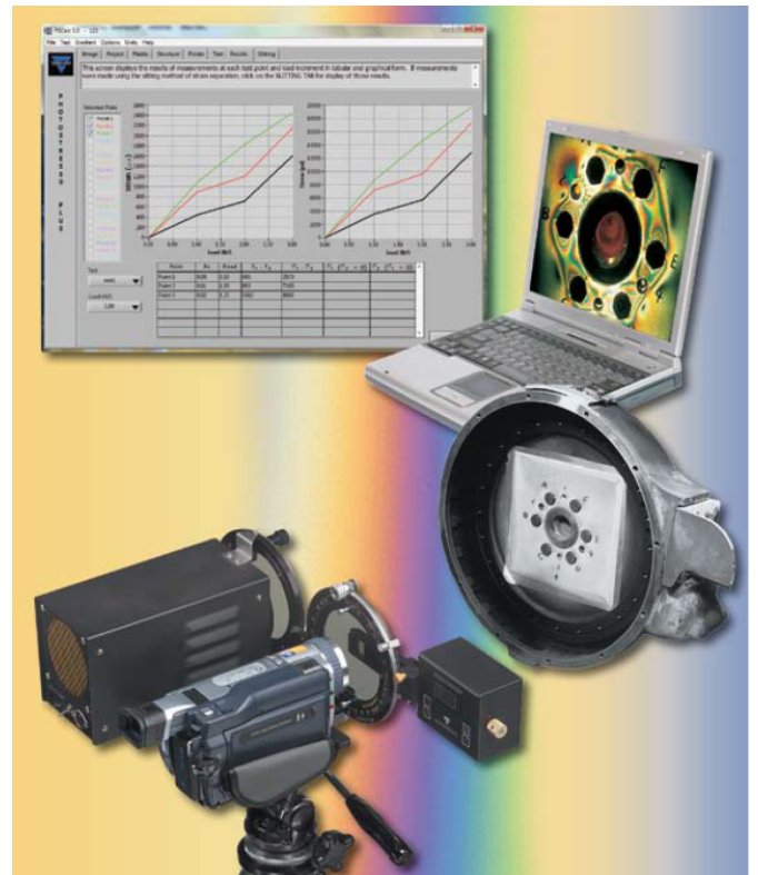
شکل ۱۱: پردازش تصویر در پولاریسکوپ انعکاسی [۱۵]
