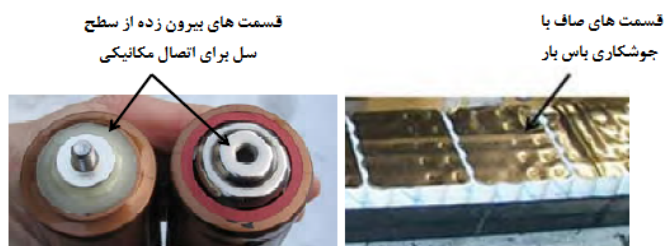
شکل ۳: (آ) اتصال مکانیکی برای تب‌های بیرون زده از سطح سلول (ب) جوشکاری مقاومتی برای تب سلول‌های استوانه‌ای [۲]
