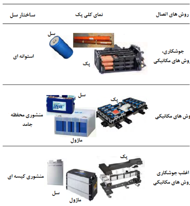
شکل ۲: مراحل اتصال پک باتری [۲]
