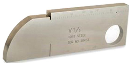
شکل ۵. نمونه‌ای از بلوک V_1 برای کالیبراسیون فراصوتی
