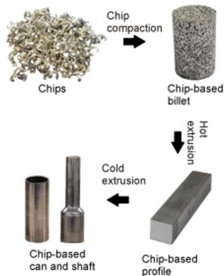
شکل ۱. بازیافت براده‌ها با استفاده از اکستروژن [۵]
