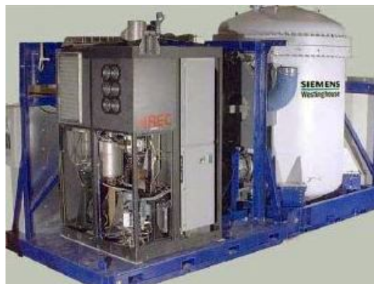
شکل ۲. سیستم هیبریدی توربین گاز و پیل سوختی شرکت وستینگهاوس [۱]
