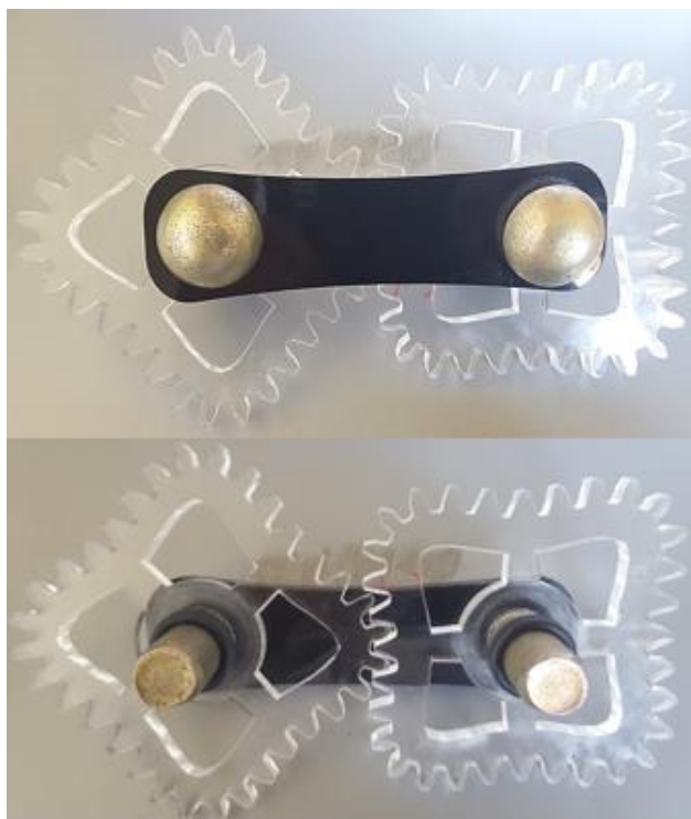
شکل ۸ مونتاژ چرخنده‌های غیردایره‌ای مربعی و بررسی نحوه درگیری آن‌ها
