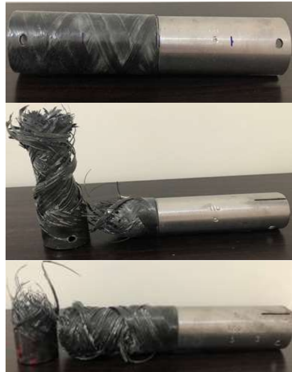
شکل ۴ نمونه‌های اتصال کربن- فولاد پس از شکست برای نمونه C110-5 با نرخ بارگذاری ۵ میلیمتر بر دقیقه، نمونه C110-5 با نرخ بارگذاری ۵۰ میلیمتر بر دقیقه و نمونه C120-5 با نرخ بارگذاری ۵ میلیمتر بر دقیقه
