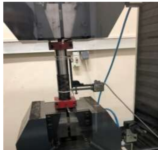
شکل ۳ نمونه در حال انجام آزمایش کشش
