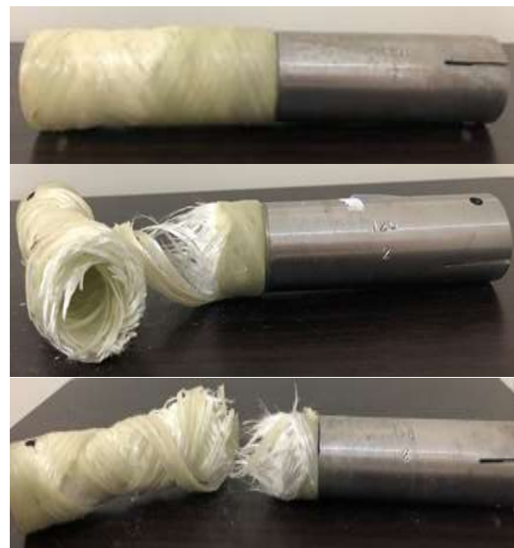
شکل ۵ نمونه‌های اتصال شیشه- فولاد پس از شکست برای نمونه G120-5 با نرخ بارگذاری ۰/۵ میلیمتر بر دقیقه، نمونه G120-2 با نرخ بارگذاری ۵ میلیمتر بر دقیقه و نمونه G120-2 با نرخ بارگذاری ۵۰ میلیمتر بر دقیقه
