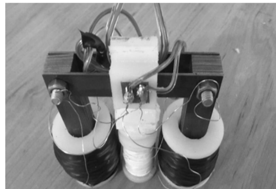
شکل ۷. شکل پروب فرستنده و گیرنده ساخته شده
