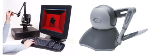
شکل ۴. رابط کاربر هپتیک Phantom ساخت شرکت Sensable
