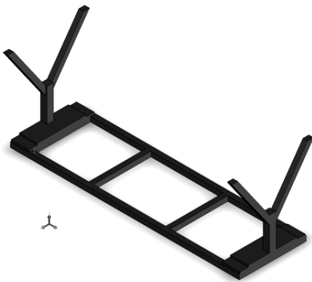
شکل ۱۰. فیکسچر طراحی شده برای اندازه گیری ممان اینرسی پهپاد حول محور یاب و پیچ
