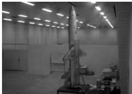
شکل ۱۳. چگونگی استقرار پهپاد روی دستگاه برای اندازه‌گیری ممان اینرسی حول محور رول
