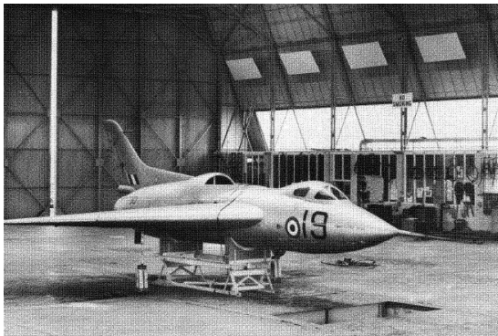
شکل ۳. اندازه‌گیری ممان اینرسی یک هواپیما با مقیاس کامل [۵]
