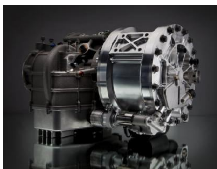
شکل ۱۰. فلاپویل سرعت بالا خودروی هیبرید ایکس. اف. [۳۳]
