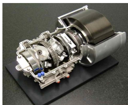
شکل ۹. فلاپویل سرعت بالای استفاده شده در مسابقات فرمول ۱ [۱۹]
