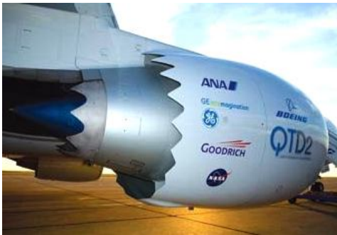
شکل ۳. استفاده از نازل چورون روی بویینگ ۷۴۷ ساخته‌شده توسط شرکت بوئینگ با همکاری ناسا و جنرال الکتریک [۶]
