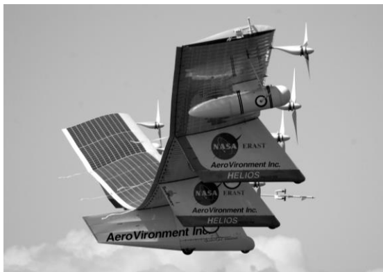
شکل ۱. نمونه‌ای از کاربرد پیل سوختی تجدیدپذیر در سیستم پیش‌ران هواپیماهای بدون سرنشین هلیوس
