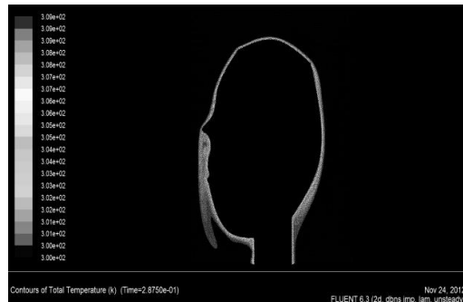
شکل ۹. توزیع دما در اطراف سر انسان در حالت ناپایدار
