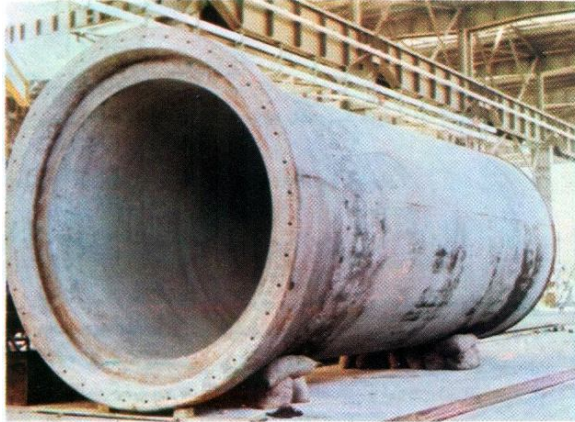
شکل ۱. نخستین لوله آزمایشی تولیدشده در کارخانه تولید لوله‌های بتنی پیش‌تنیده آب آذربایجان شرقی
