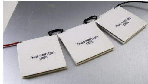
شکل ۹. چیدمان سری المان‌ها از نظر جریان الکتریکی
