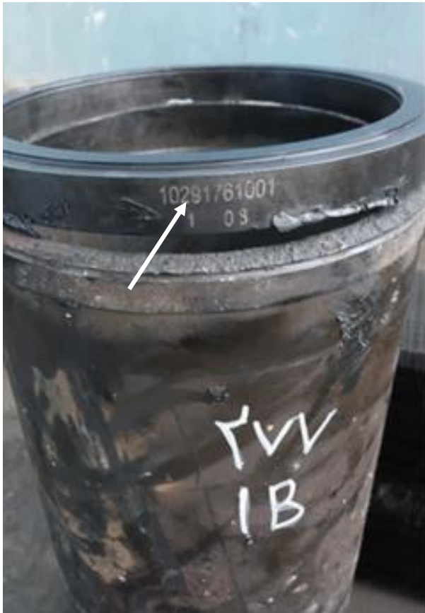
شکل ۴ شکستن لاینر B از محل فلنج
