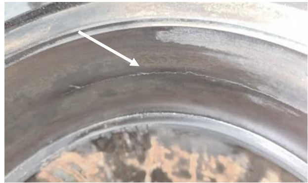
شکل ۶ ترک خوردن لاینر B
